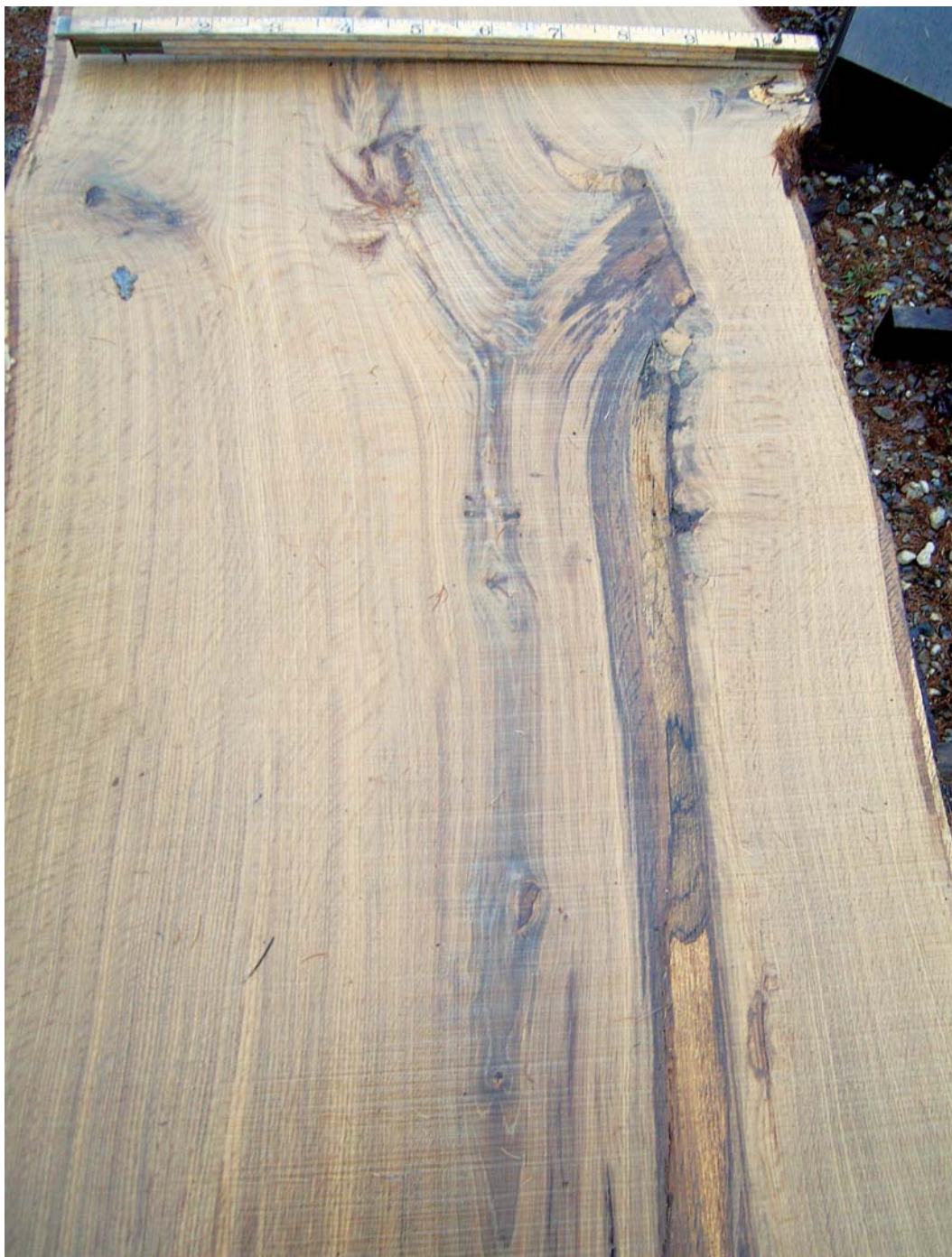
Beskæringen er her foretaget for sent. Resultatet er udbredt vertikalt råd. Foto: H.C. Graversgaard, Skovdykkerne.
