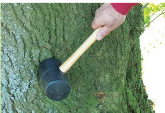
Figur 1. Slag med resonanshammer medfører en hul lyd hvis stammen har råd eller hulhed.
