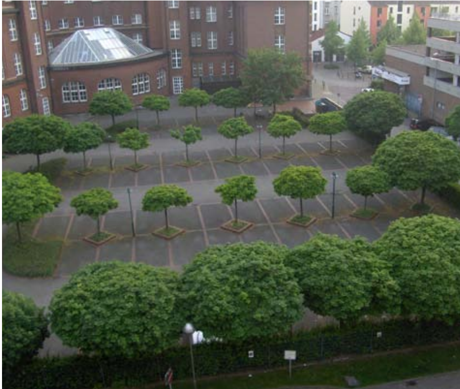
Bilden visar gatuträds olika utveckling p.g.a av platsens skiftande markförutsättningar. De centralt placerade träden i hårdgjord yta har sämst växtförutsättningar. Träden med bättre utvecklade kronor har rotkontakt med vegetationsytor och därmed större växtvolym. (Foto: Johan Östberg)
