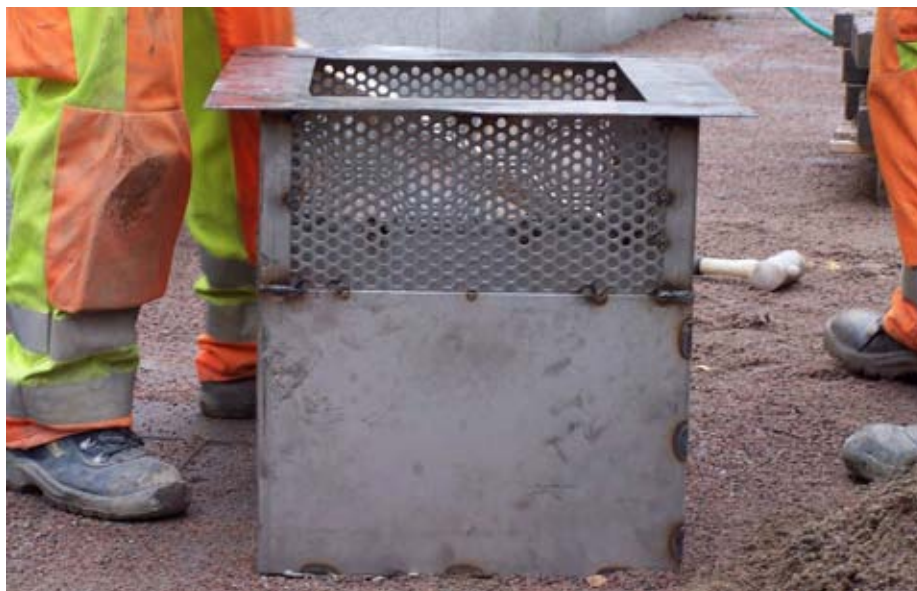
Luftbrunn typ TVL 2333 Clarova. Brunnen placeras direkt ovanpå skelettjorden. Brunnen för ned dagvatten i skelettjorden och sørjer samtidigt för lufttillgång vilket möjliggör det för träden livsviktiga gasutbytet i marklagren. Det finns även brunnar på marknaden där hela sidorna perforerats. (Foto: Björn Embrén)
