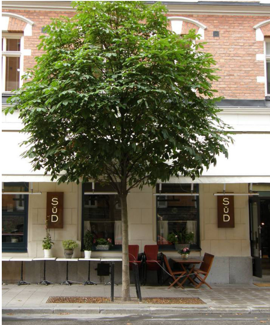
Neuer Strassenbaum in der Swedenborgsgatan in Stockholm. Ältere Bäume sind gegen neue ausgetauscht worden. 15 m 3 verdichtungsbarer Boden/Baum und eine luftige Tragschicht wurden unter die Versiegelung verlegt. (Foto: Björn Embrém)
