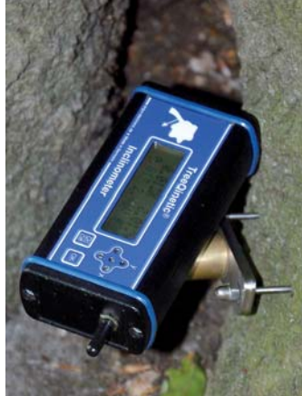
Rodbevægelsesmålerne sættes på rødder eller rodanløb med to skruer og nulstilles før måling.
