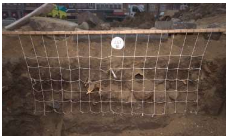
Figur 20: Målegitter til opgørelsen af rodvækst. Det ses at de øverste 20 cm af profilet udgøres af belægningsopbygningen, efterfulgt af det ca 60 cm dybe lag gartnermacadam (foto: Søren Schaumburg Jensen).
