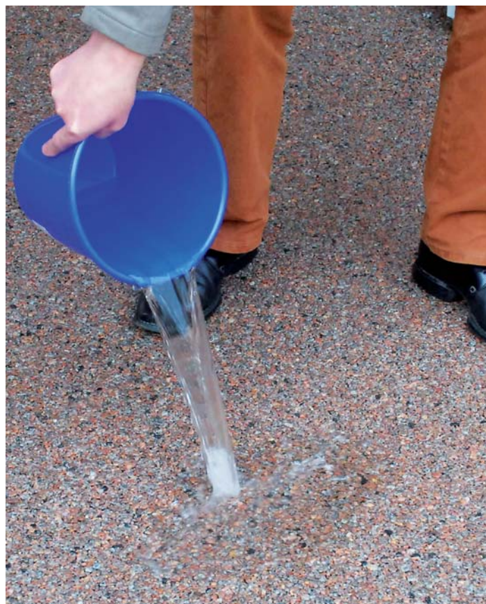
Den ekstremt permeable Elastopave fra HansaGrand tillader gennemløb fra 4000 liter vand/m 2 /time. Foto: Christian Nørgård Nielsen.
